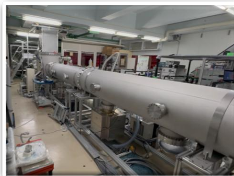
図 7-5 OEC レーザーの原理(左)、大阪大学設置の 15 m OEC 装置(右)
